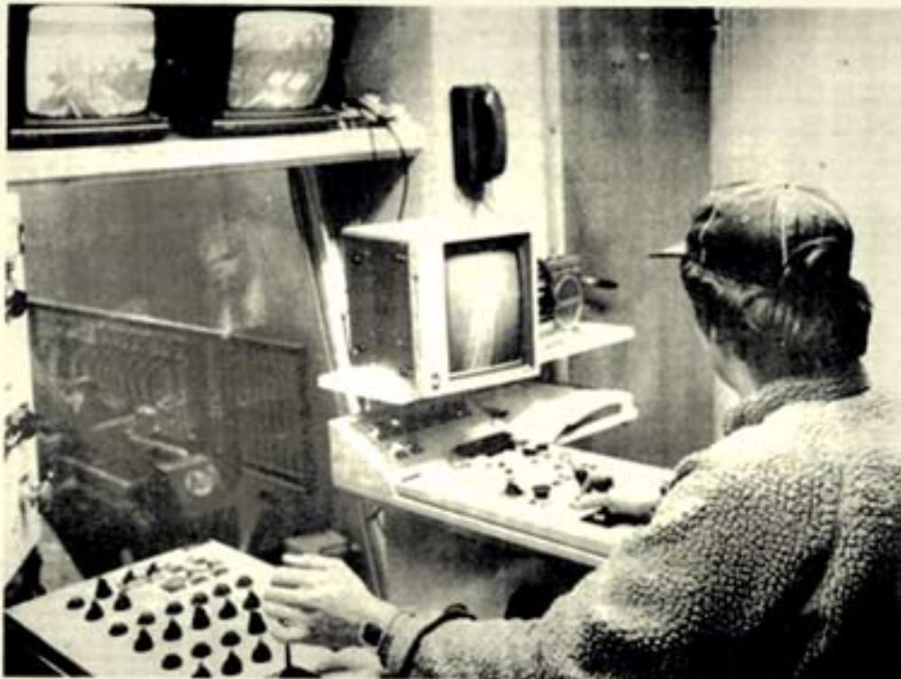
Sjören Gejbo styr en stor del av sågverket via ett mansbordbord. Via TV-monitorer håller han koll på vad som händer på de oörmannade platserna.
